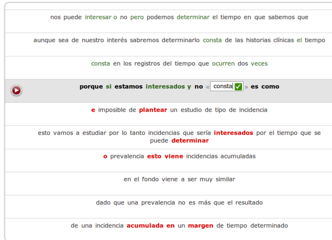
Fig. 3: Reproductor web de transLectures en modo interacción inteligente. Las palabras con baja confianza (probablemente erróneas) aparecen en rojo, y las revisadas en verde. La caja de edición puede ser expandida a izquierda y derecha pulsando en << ó >>, respectivamente.
